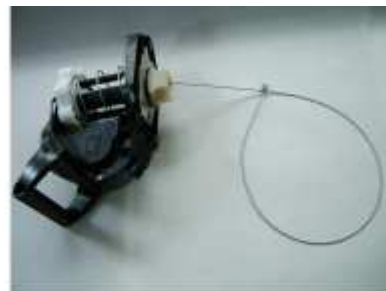
Vista laterale del tra meccanico con gli assi sfilati e cavetto di recupero completamente svolto. In questa condizione deve essere tenuto lo stato di lavoro e dopo ogni ciclo a separare dal supporto.
