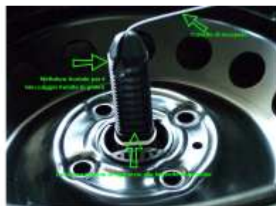
Particolare della ruota di scorta sganciata al il recupero, con con il perno di sostegno ancora collegato al cavetto di recupero.
