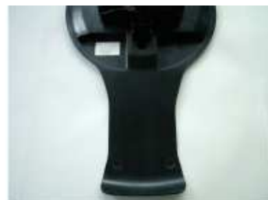
Particolare della piastra di appoggio della ruota di scorta, parte nella ruota e del perno di sostegno.
